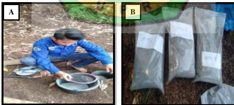
Gambar 4.5. A. Proses pengayakan sampel dengan ukuran mes 40 B. Sampel yang sudah diayak dengan ukuran material yang sama
